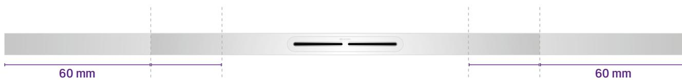
Stufenlos kürzbar, bei Verwendung von Verbindungsstücken bis zu 60 mm an beiden Seiten
